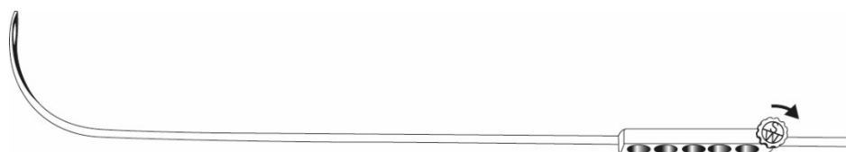
Fig. 9: Griff in der gewünschten Position mit der Fixierschraube im Uhrzeigersinn festdrehen. / Tighten the handle in the desired position by turning the fixing screw clockwise.
